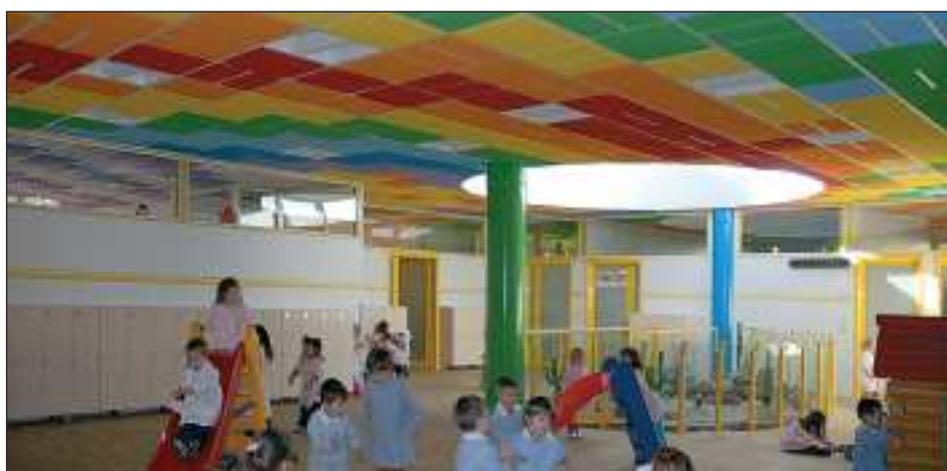
Isolamento fonoassorbente e termoisolante con controsoffitto in sughero preformato e pretinteggiato Kontro
