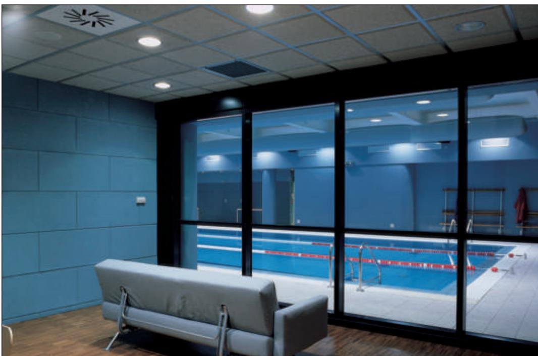
Kontro: controsoffitto in sughero preformato e pretinteggiato che oltre a garantire ottime prestazioni per l'isolamento termoacustico è un materiale salubre, naturale ed ecocompatibile. SoKoVerd.C1: rivestimento in sughero delle pareti particolarmente adatto alla protezione delle strutture edili esposte negli ambienti molto umidi.
