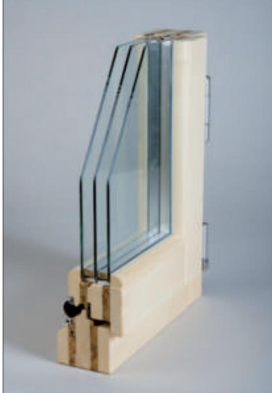
*Soluzione esemplare dell'impiego a sandwich con pannello di sughero biondo KoFlex nei montanti in legno dei serramenti contenendo lo spessore in 78mm e ottenendo un indice di trasmittanza pari a U 0,80 W/m<sup>2</sup> K.*
