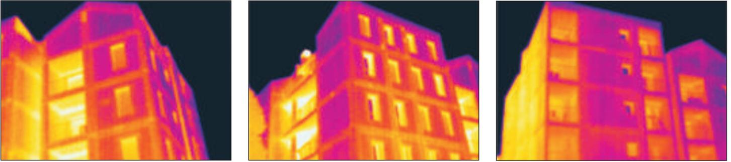
Le immagini termografiche evidenziano la struttura travi, corree, pilastri e pareti di tamponamento che compongono l'edificio. Lo strumento permette di evidenziare i ponti termici sulla base del rilievo bidimensionale delle temperature superficiali.
