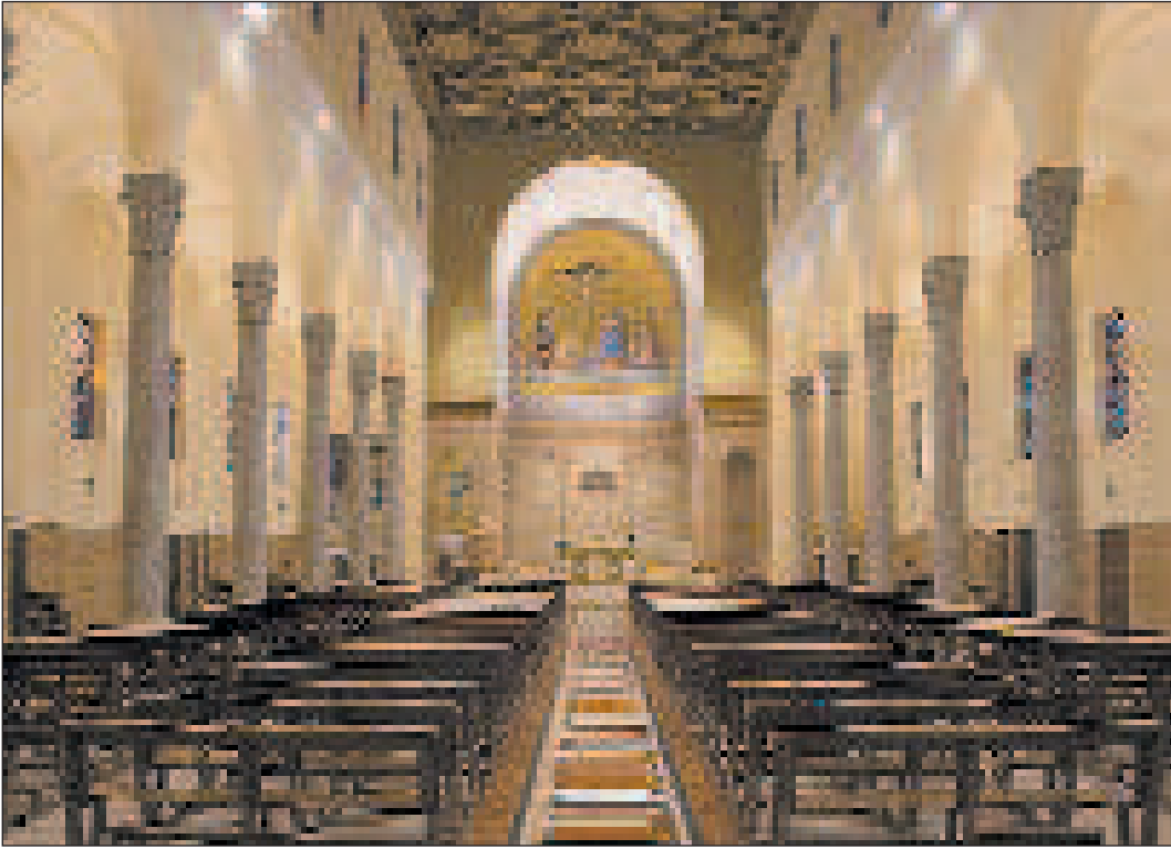
Vista dopo l'intervento di bonifica acustica eseguita con l'applicazione del rivestimento alle pareti laterali e al frontale posteriore con pannelli in sughero biondo naturale preformato e pretinteggiato SoKoVerd.C1. Impresa esecutrice: Thema Costruzioni srl Milano
