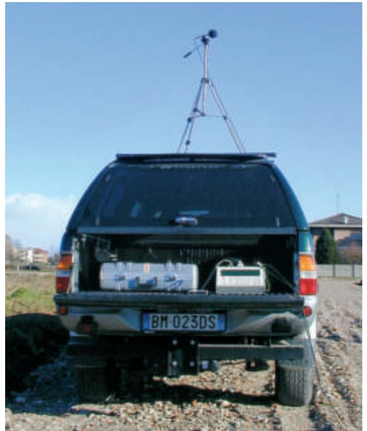
Fase di rilievo fonometrico per la preparazione della valutazione previsionale del clima acustico
