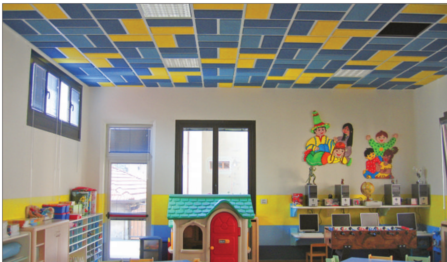
Il controsoffitto in sughero Kontro ha eliminato il "rimbombo" che causava stress ai bambini e insegnanti.
