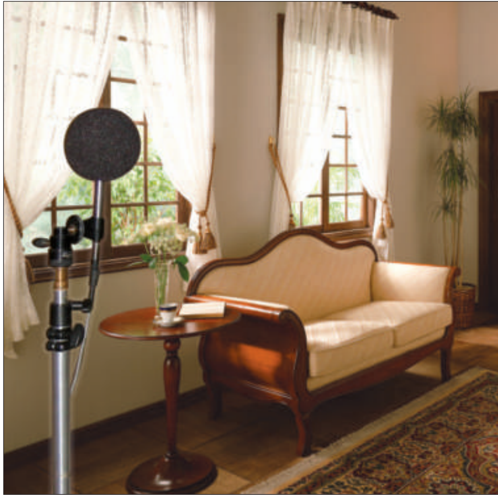
Fase operativa di verifica in opera dei requisiti acustici di un alloggio.
