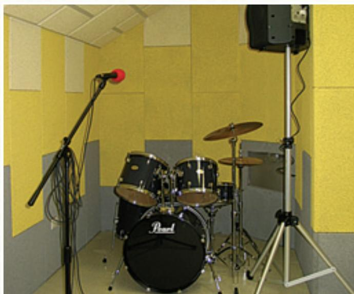
Sala prove con pacchetto fonoisolante e rivestimento fonoassorbente in sughero preformato e pretinteggiato SoKoVerd.C1 delle pareti e soffitto.
