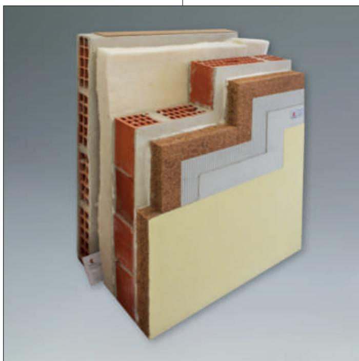
Parete perimetrale esterna. Isolamento interno mediante inserimento nell'intercapedine di pannelli in lana di pecora Lankot. Isolamento esterno mediante rivestimento a cappotto in sughero BioVerd, intonaco di spessoramento KoMalt.G e finitura con intonaco KoSil ai silicati di potassio.
