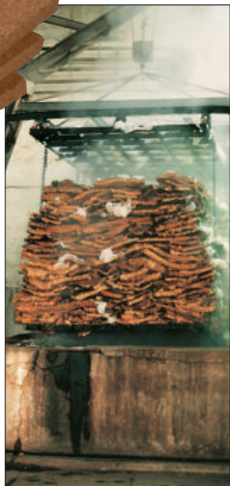
Fase di bollitura delle cortecce di sughero
