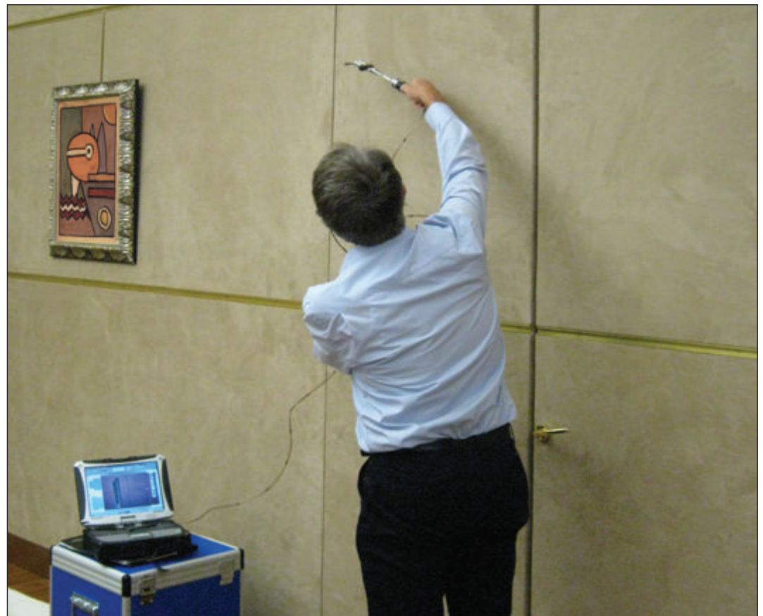
Mappatura acustica con sonda intensimetrica e tracciatore ottico di una porta fonica, eseguita in un ambiente privato dallo staff tecnico della Divisione Acustica di Coved.
