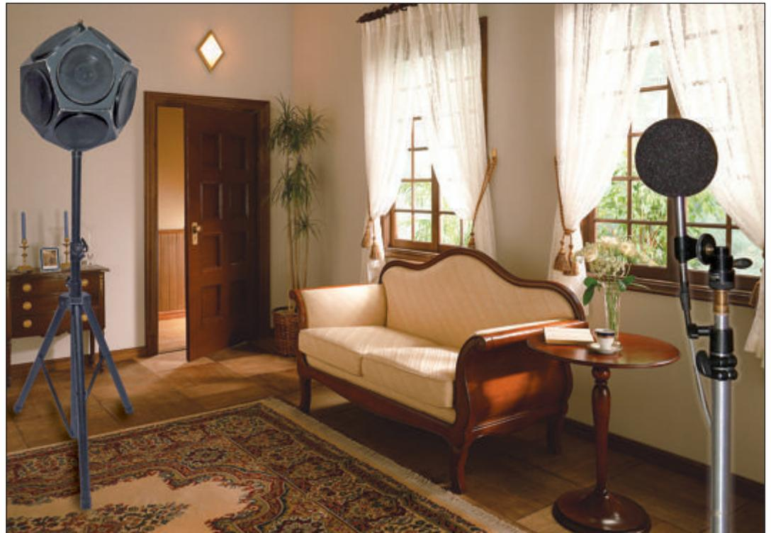
*Fase operativa di rilievo mediante microfoni e verifica in opera dei requisiti acustici di un alloggio.*
