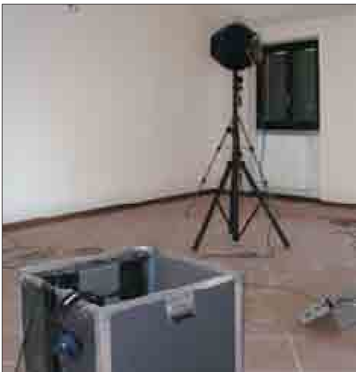
Fase di collaudo acustico divisorio verticale eseguito dal Tecnico Competente in Acustica Ambientale della CoVerd
