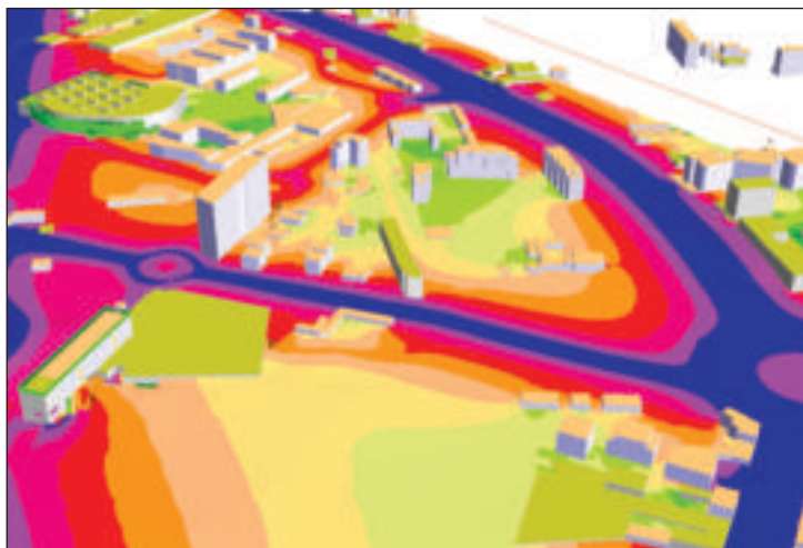
Mappatura al reale dei livelli di rumore per la realizzazione del "Polo Istituzionale" e di un "Centro servizi polifunzionale privato" nel Comune di Monza (MI) Elaborato dalla Divisione Acustica di Coverd.
