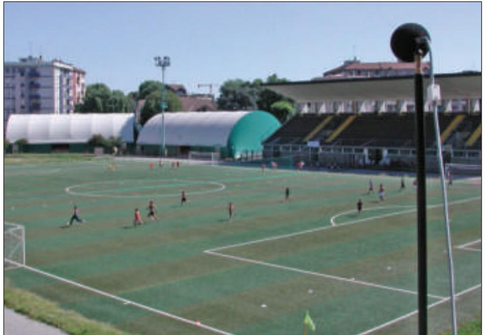
*Operazioni di monitoraggio fonometrico in prossimità di un impianto sportivo*
