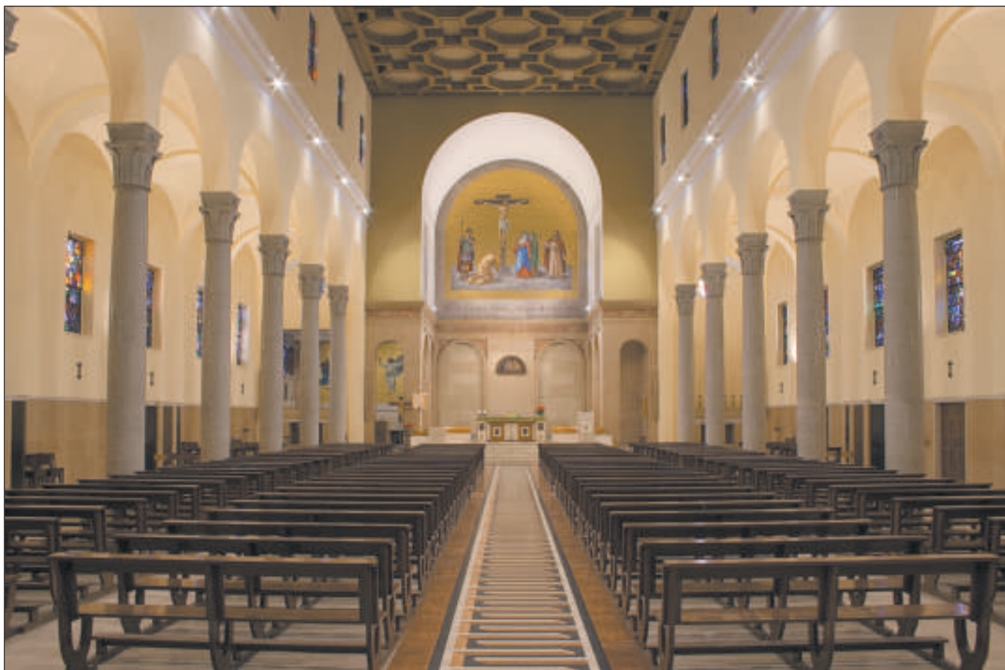
La chiesa è un ambiente dove l'effetto del riverbero può dare molto fastidio. L'intervento di correzione acustica va studiato tenendo conto delle caratteristiche architettoniche e del risultato estetico. Nell'esempio in foto, l'uso dei pannelli di sughero SoKoVerd.C1 si integra perfettamente con l'esistente. Leone XIII Milano
